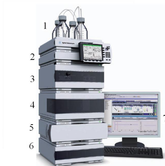
Rys. 1. Widok współczesnego chromatografu cieczowego, HPLC, Agilent 1260 (Agilent, Palo Alto, USA) [5]. Zbiornik z fazą ruchomą (1), system odgazowywania fazy ruchomej (2), pompa (3), dozownik (4), kolumna (lub zestaw kilku kolumn) termostatowanych (5), detektor (6), komputer (7).
