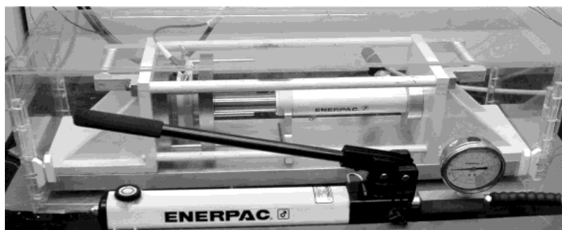
Rys. 15. Doświadczalna aparatura do PPEC wg Nurok'a i wsp. [194]
